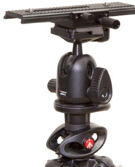
Trilho de foco simples montado sobre cabeça de tripé
