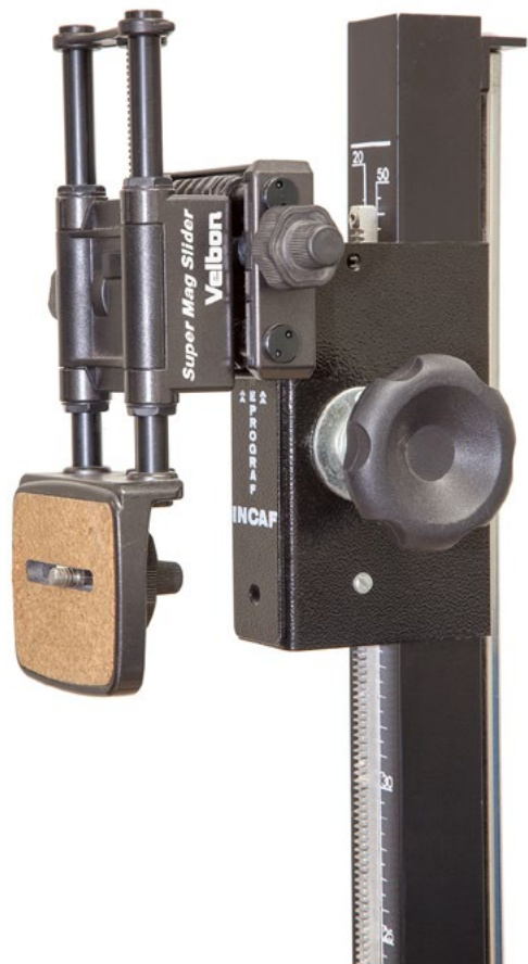
Trilho de foco simples montado em coluna de mesa de cópia artesanal.
